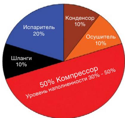
Распределение масла по системе кондиционирования (Справочные значения, фактические значения зависят от температуры окружающего воздуха и нагрузки на двигатель.)
