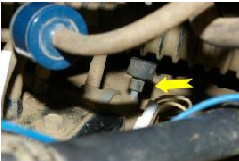
Рис.8. Воздушный фильтр электромагнитного клапана включения 4WD
