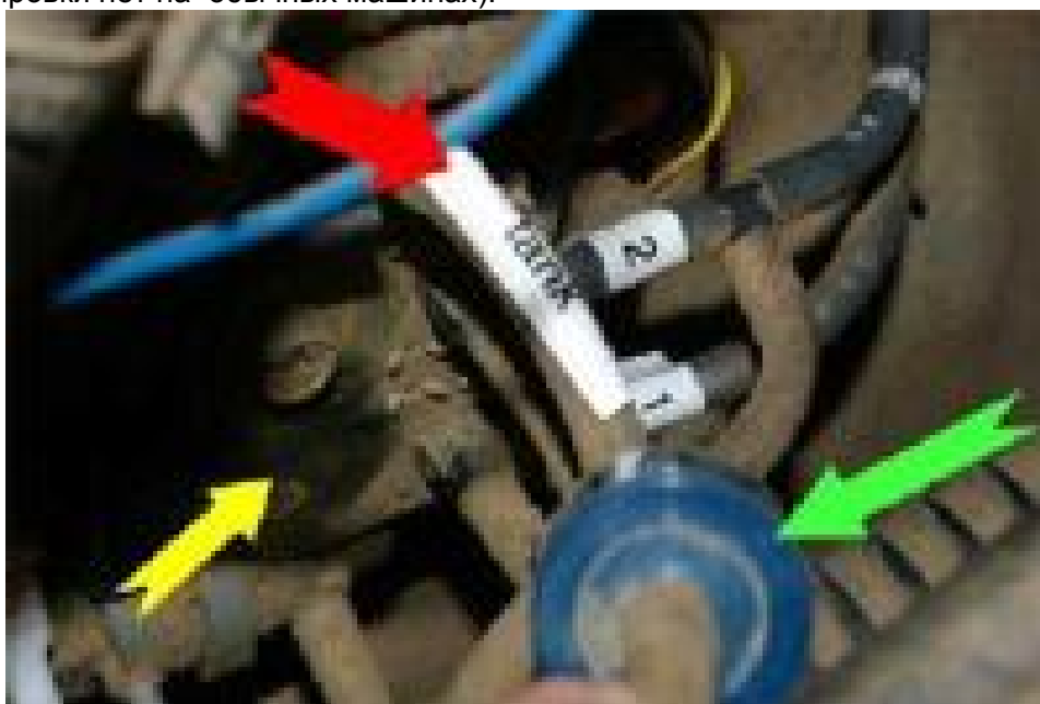
Рис.5. Блок VSV1 и VSV2 клапанов
