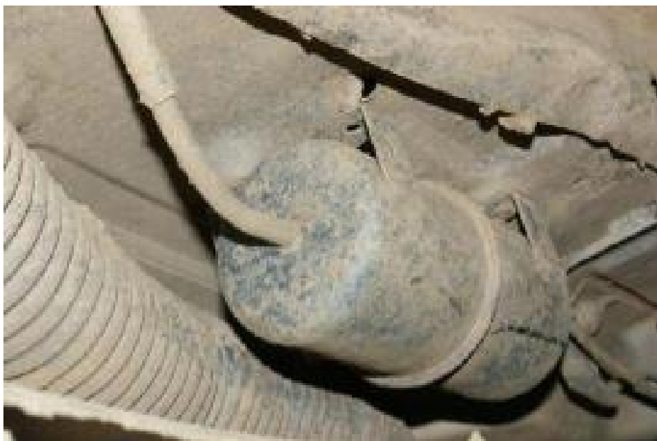
Рис.6. Вакуумный ресивер
