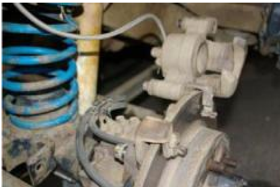
Рис.10. «Блокирующая и разблокирующая» трубки (обе в черной оплетке)- «разблокирующая трубка находится снизу и подключена к боковой (передней) части хаба.
