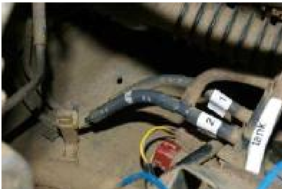
Рис.7. Вакуумные трубки
