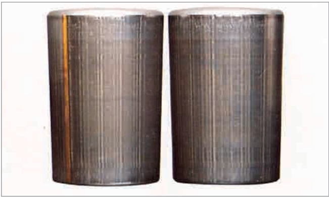
Фото 7-15-2 Деталь: Бочкообразные ролики с фото 17-15-1 Симптом: Полосовой характер коррозии на поверхности ролика
