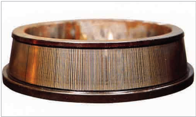
Фото 7-15-1 Деталь: Внутреннее кольцо конического роликоподшипника Симптом: Полосовой характер коррозии на поверхности дорожки качения
