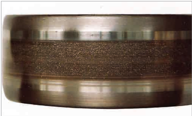
Фото 7-15-3 Деталь: Внутреннее кольцо подшипника качения с цилиндрическими роликами Симптом: Характерный полосовой след электрохимической коррозии, сопровождаемый следами язвенной коррозии на поверхности дорожки качения
