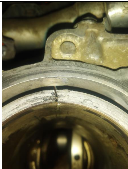
Фото 9.10. Вид на характер повреждения гильзы 4-го цилиндра
