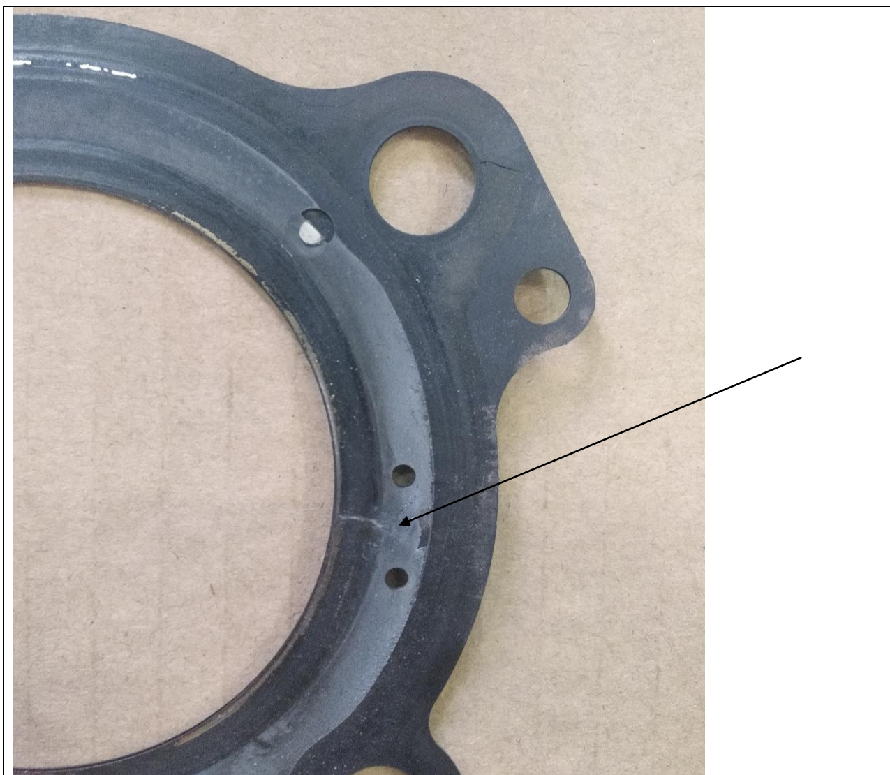
Фото 16. Вид на место повреждения прокладки ГБЦ
