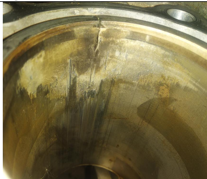
Фото 9.10. Вид на характер повреждения гильзы 4-го цилиндра
