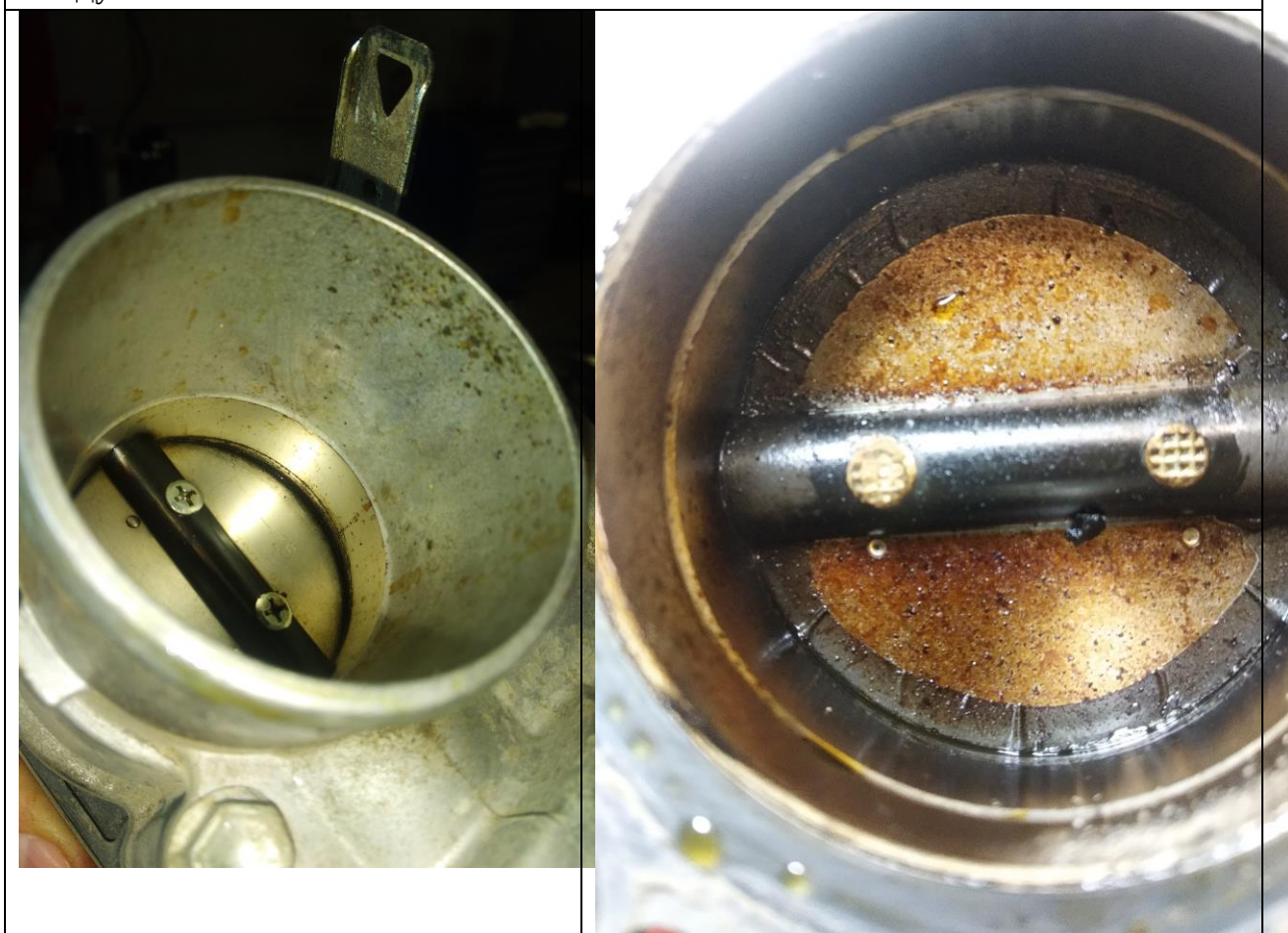
Фото 26.27. Вид на заслонку дроссельного патрубка с внешней и внутренней стороны
