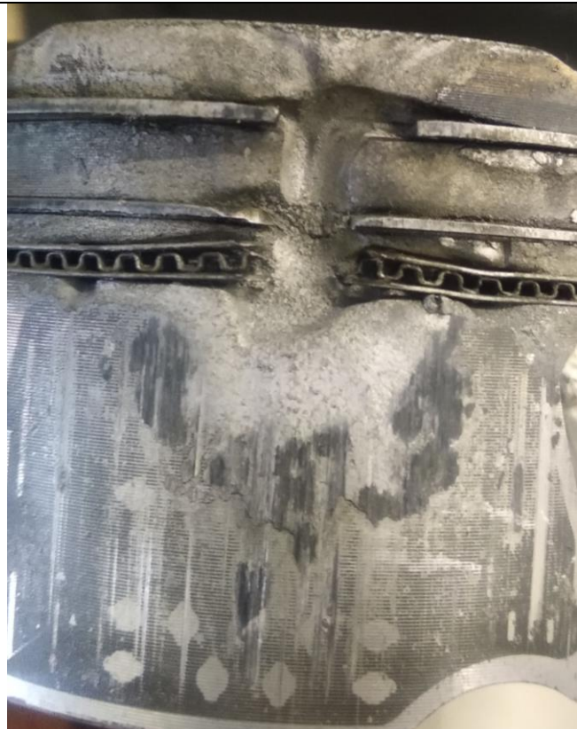
Фото 7. Вид на прогар поршня с нагруженной стороны
