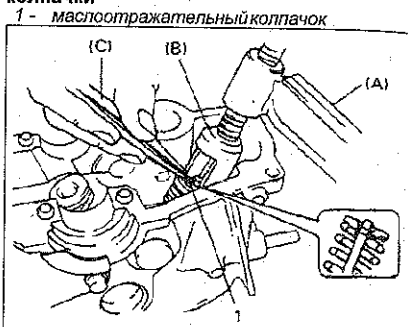
5.42 Сожмите пружину на стержне клапана с помощью оправки и установите сухари 1 пинцетом в паз на стержне
