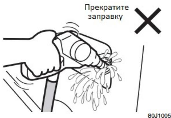
\* В зависимости от типа заправочной колонки функция автоматической остановки может быть активирована раньше, и заправка может оказаться невозможной. Следуйте инструкциям сотрудника АЗС.
