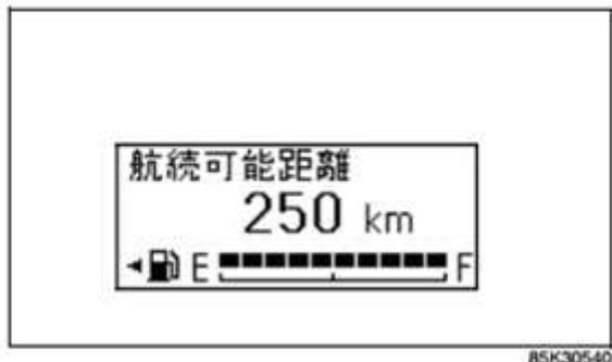
Отображается приблизительное расстояние, которое вы можете проехать с текущим запасом топлива.
