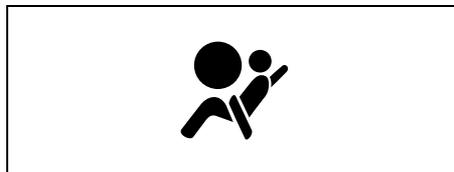
При включении зажигания в положение «ON», этот индикатор загорается на несколько секунд, и указывает на его правильное функционирование.
