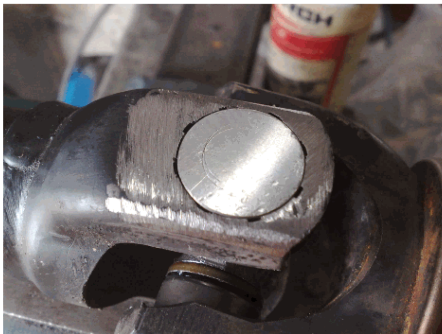
Рис. 5. Установка шайбы.
