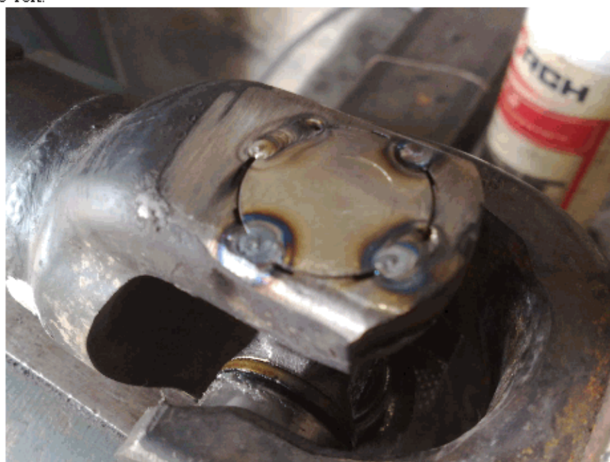
Рис. 6. Фиксируем сваркой шайбы.
