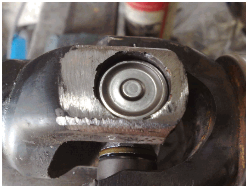
Рис. 3. Установка чашки крестовины
