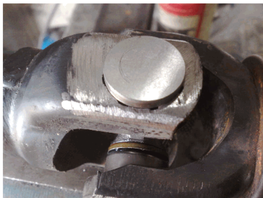
Рис. 4. Установка шайбы
