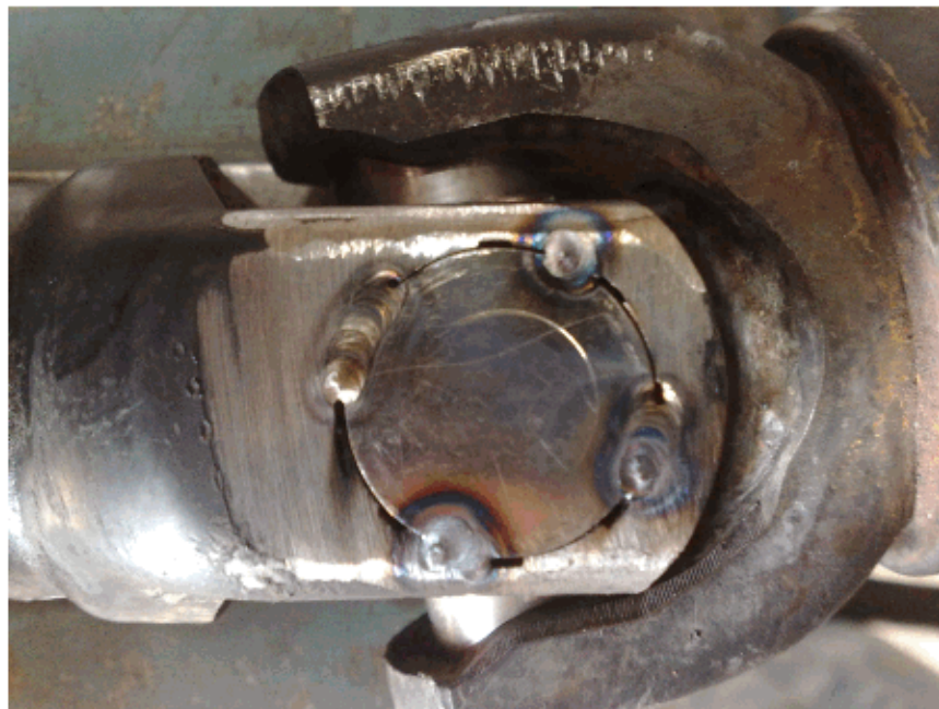
Рис. 7. Фиксируем сваркой шайбы.
